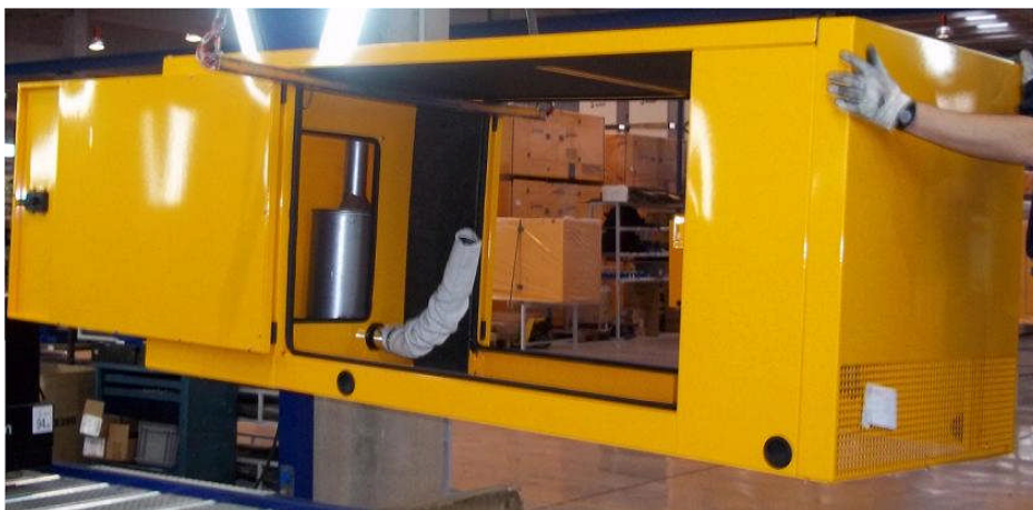
Abbildung 38- Mit Kran angehobenes Schallschutzgehäuse.
