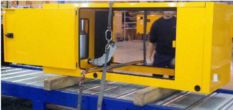
Abbildung 37 - Schallschutzgehäuse mit offenen Seitentüren.
