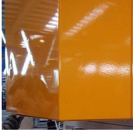
Abbildung 29- Blechgehäuse für Baugruppe Schalldämpfer-Abgasrohr.
