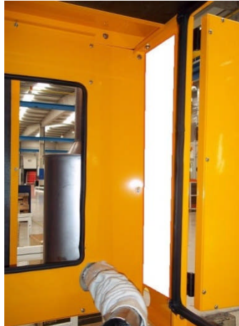
Abbildung 33- Lage des abzunehmenden Schallschutzes.
