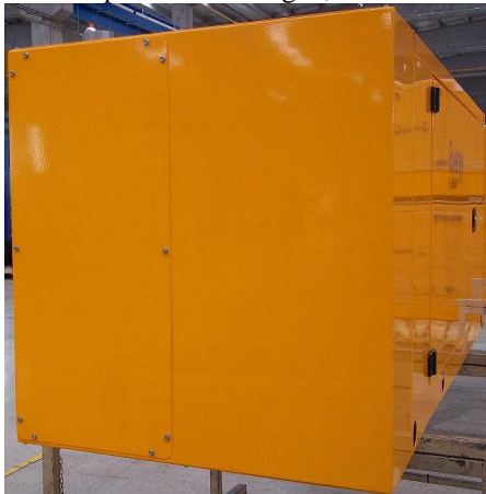
Abbildung 34- Seitenwand des Schallschutzgehäuses.
