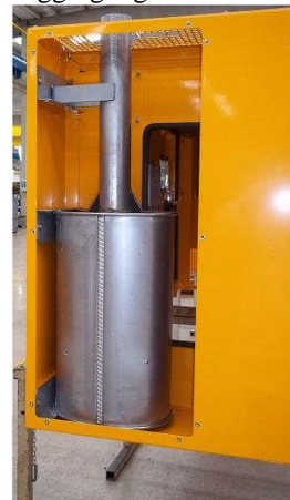
Abbildung 35- Im Schallschutzgehäuse montierter Schalldämpfer.
