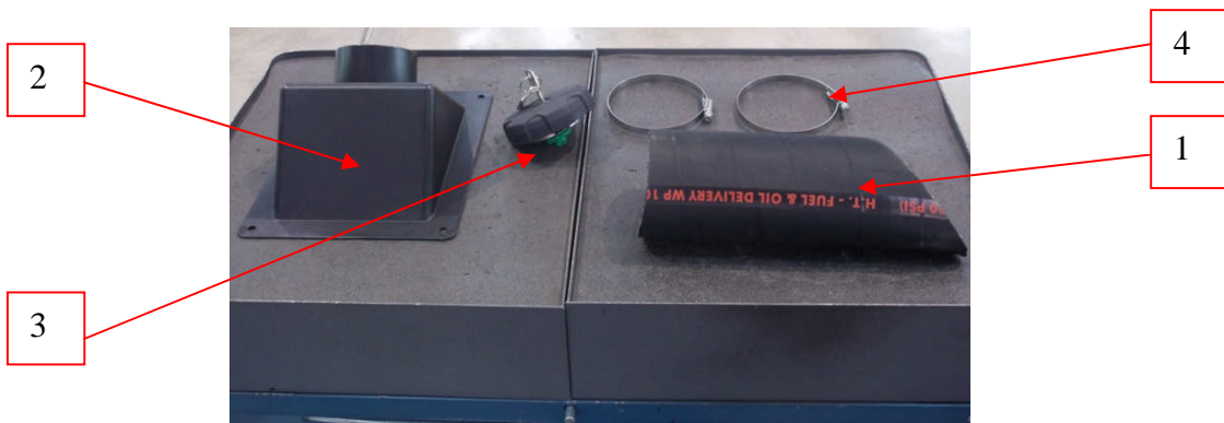
Abbildung 46- Komponenten für die Montage des Kraftstoffstutzens.
